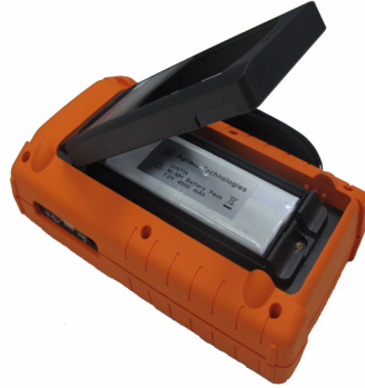
그림 8-5 스탠드를 분리하지 않고 배터리 팩 커버를 분리합니다
