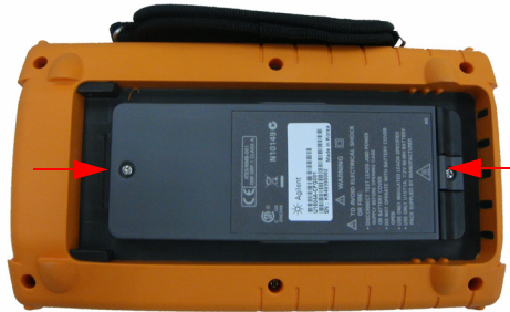
그림 8-3 배터리 커버 나사를 분리합니다
